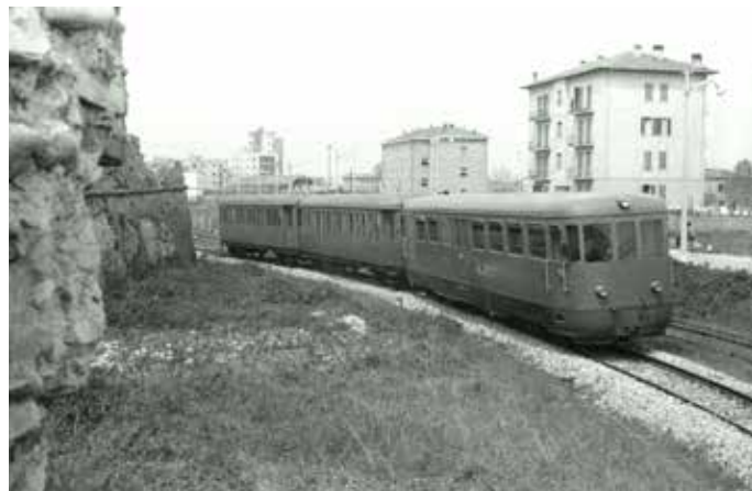
Un treno formato dall'automotrice ALn 52.10 e due carrozze passeggeri all'uscita della stazione Rimini Centrale delle ferrovie Padane (fotob D.Curzi).
